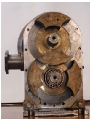
Wnętrze i widok ogólny prototypu pompy z wirującymi tłokami MP-05 Bolesława Kuźniewskiego (fot. archiwum Adama Komorowskiego)
