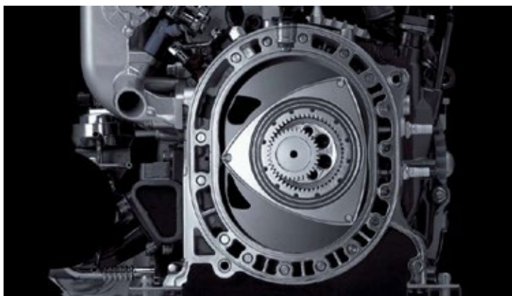
Przekrój silnika Mazda RX-8 (źródło: https://carfromjapan.com/article/car-maintenance/mazda-rx8-engine-rebuild/ [dostęp: 31.12.2022])
